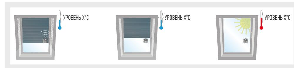
Температуру внутри помещения можно установить, используя освещенность и тепловое воздействие солнца. Например, если зимой температура опускается ниже установленного уровня, а на улице светит солнце, датчик автоматически открывает шторы, поднимает рольставни или маркизы, позволяя свету проникать в помещение и нагревать его, и наоборот.
